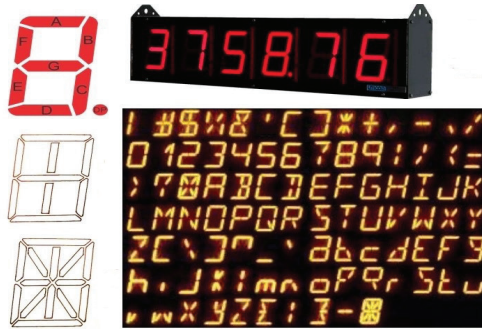
شکل ۱۶. نمایشگرهای قطعه‌خطی برای ارقام، حروف الفبای لاتین، و علائم ویژه. تصویر راست برگرفته از
