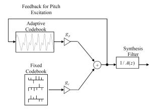
Figure 5. Code-Excited Linear Prediction (CELP) Decoder.
