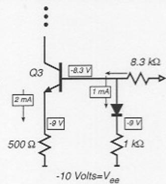
$$R_{out3} = r_{ce3} \left[ 1 + \frac{R_{EE3}}{r_{e3}} \frac{R_{be3}}{R_{be3} + R_{E3} + R_{b3}} \right] = 994 \text{ k}\Omega$$
