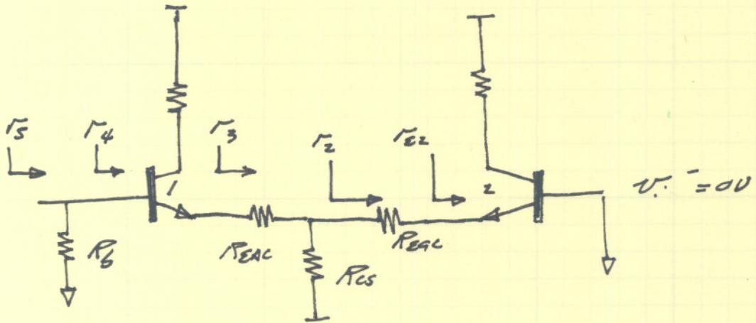
$$r_2 = r_{e2} + R_{EAC}$$
