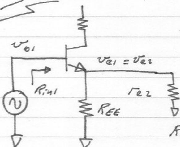
$$\frac{v_{e1}}{v_{o1}} = \frac{R_{leg}}{R_{leg} + r_{e1}} \approx \frac{R_{EE} // r_{e2}}{r_{e1} + R_{EE} // r_{e2}}$$
