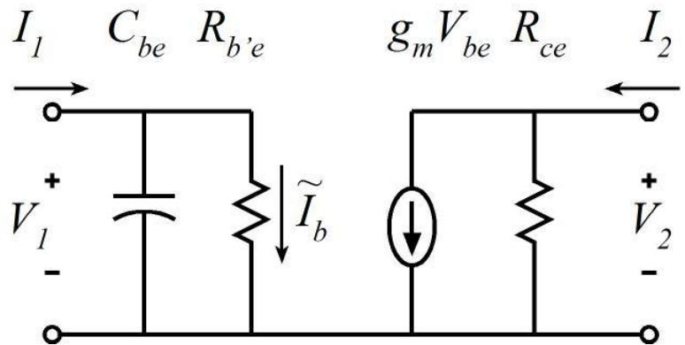
$$\begin{bmatrix} V_1 \\ I_2 \end{bmatrix} = \begin{bmatrix} h_{11} & h_{12} \\ h_{21} & h_{22} \end{bmatrix} \begin{bmatrix} I_1 \\ V_2 \end{bmatrix}$$
