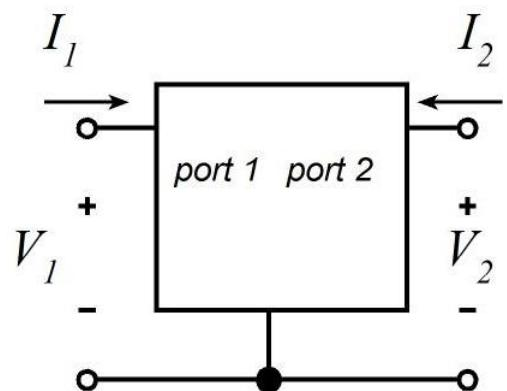
$$\begin{bmatrix} V_1 \\ I_2 \end{bmatrix} = \begin{bmatrix} h_{11} & h_{12} \\ h_{21} & h_{22} \end{bmatrix} \begin{bmatrix} I_1 \\ V_2 \end{bmatrix}$$
