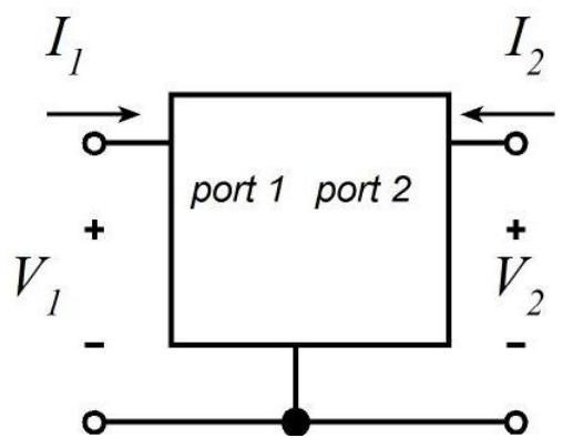
$$\begin{bmatrix} V_1 \\ V_2 \end{bmatrix} = \begin{bmatrix} Z_{11} & Z_{12} \\ Z_{21} & Z_{22} \end{bmatrix} \begin{bmatrix} I_1 \\ I_2 \end{bmatrix}$$
