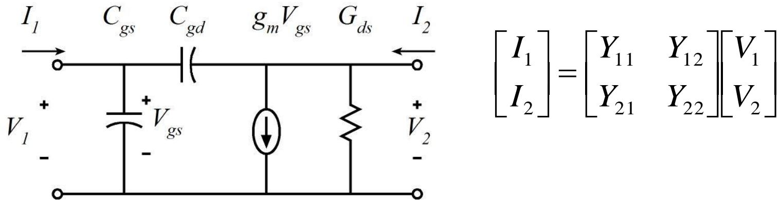
$$\begin{bmatrix} I_1 \\ I_2 \end{bmatrix} = \begin{bmatrix} Y_{11} & Y_{12} \\ Y_{21} & Y_{22} \end{bmatrix} \begin{bmatrix} V_1 \\ V_2 \end{bmatrix}$$
