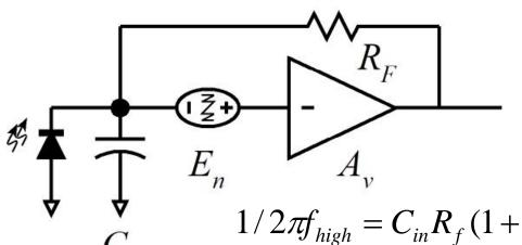
$$\begin{split} S_{E_n E_n}(f) &= 4kT\Gamma / g_m + 4kT(R_s + R_g + R_i) + \dots \quad \text{(FET)} \\ S_{E_n E_n}(f) &= 2kT / g_m + 4kT(R_{bb} + R_{ex}) + 2qI_bR_{bb}^2 + \dots \quad \text{(BJT)} \end{split}$$
