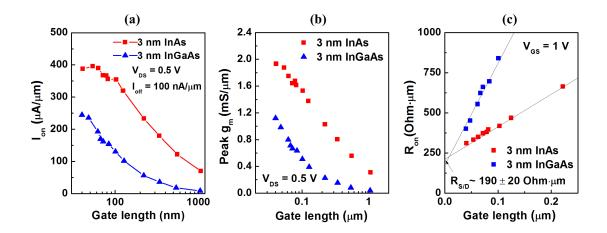
Figure 4.8: (a)  $I_{\rm on}$  vs.  $L_{\rm g}$  at 100 nA/ $\mu$ m  $I_{\rm off}$  and V<sub>DS</sub>=0.5 V. (b) Peak  $g_{\rm m}$  vs.  $L_{\rm g}$  at V<sub>DS</sub>=0.5 V. (c)  $R_{\rm on}$  vs.  $L_{\rm g}$  at V<sub>GS</sub>=1 V.
