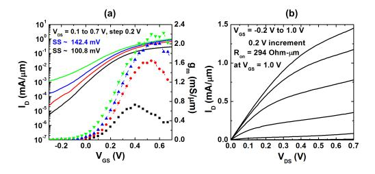
Figure 7.3: (a)  $I_{\rm D}$ - $V_{\rm GS}$  of a 20 nm- $L_{\rm g}$  device. (b)  $I_{\rm D}$ - $V_{\rm DS}$  of a 20 nm- $L_{\rm g}$  device.
