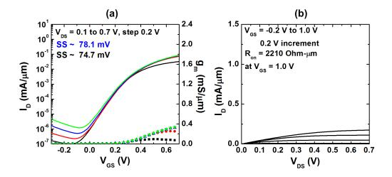
Figure 7.4: (a)  $I_{\rm D}$ - $V_{\rm GS}$  of a 1  $\mu$ m- $L_{\rm g}$  device. (b)  $I_{\rm D}$ - $V_{\rm DS}$  of a 1  $\mu$ m- $L_{\rm g}$  device.
